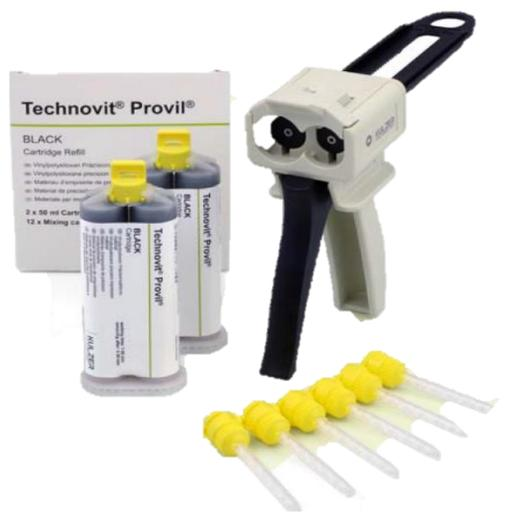
Technovit Provilは、複雑な形状の型取りに適した低粘度のシリコン樹脂です。ディスペンシングガン、カートリッジ、混合チューブから構成されており、ガンのレバーを引くだけで樹脂が均一に混合されます。安全でミスのない作業が可能です。混合されて出てきた樹脂は、試料に直接塗布することが可能です。小さな空洞や穴に適用する場合、精密作業用のアタッチメントがご利用頂けます。
