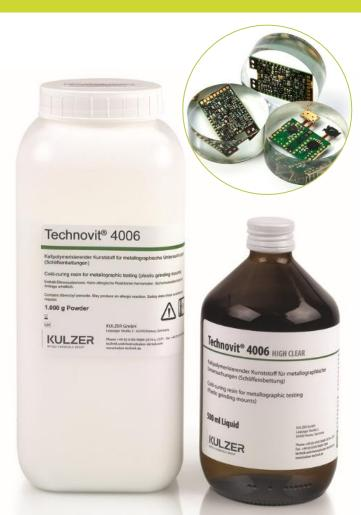
Technovit 4006 は、4004よりさらに透明度が高く、 熱ストレスが低いアクリル系冷間硬化樹脂です。粉 末、リキッドの 2 成分で硬化させます。
