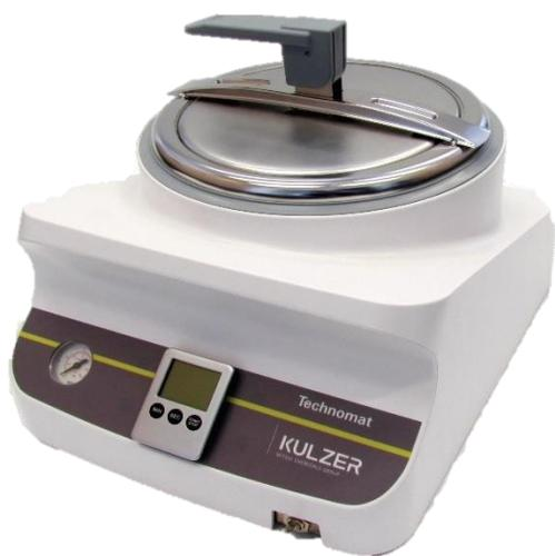
Technomatは、約 2.0 気圧まで加圧が可能なコンパクト圧力容器です。短時間硬化樹脂用に特別に設計されています。Technomatを使用することで、気泡がなく、高品質のテストサンプルを作成することが可能です。特にTechnovit 4004、4006などの透明なTechnovit商品に対して利用することで、気泡の少ない透明度を持つ樹脂包埋が実現出来ます。
