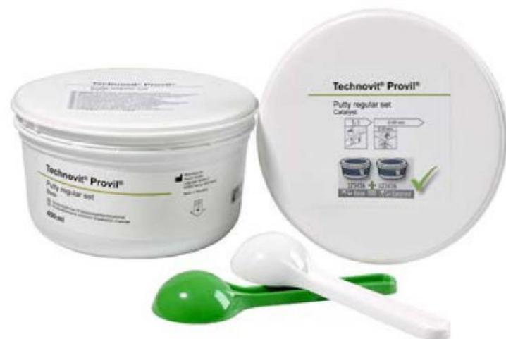
Technovit Provil パテは、基材と硬化剤から構成されるシリコン製樹脂で、1 : 1 の比率で手でこねて利用します。こねた樹脂を手で試料に押しつけることによって転写できます。樹脂は約 5 分後には剥離可能な程度に硬化します。硬化後の硬さの違いに応じて、レギュラーとソフトの2種類をご選択いただけます。
