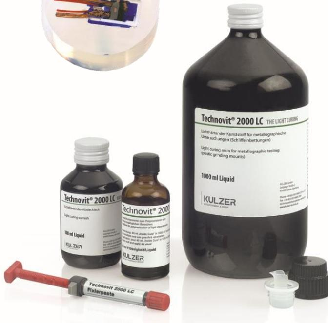
Technovit 2000 LC は、ブルーライトを照射するだけで、低温で硬化させることが可能な、透明樹脂です。PE製モールドに充填し、専用のテクノトレイ光照射装置の中で硬化させます。
