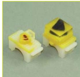
Technovit 3040 は上記のヒストブロックと組み合わせて使用する固定用樹脂です。メチルメタクリレート(MMA)をベースにしており、混合後速やかに硬化(約 5 ~ 10 分)し、ブロックと包埋された試料をしっかりと固定いたします。
