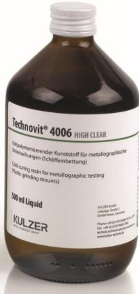
Technovit 4006 は、4004よりさらに透明度が高く、熱ストレスが低いアクリル系冷間硬化樹脂です。粉末、リキッドの 2 成分で硬化させます。
