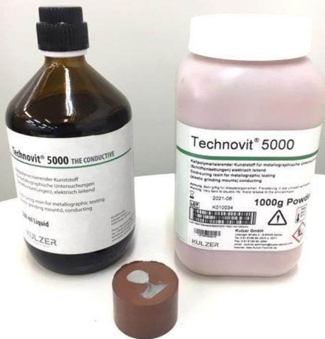
Technovit 5000 は、アクリルをベースにした速硬化性の樹脂です。粉末、リキッドの 2 成分で硬化させます。
