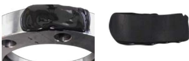
Technovit Provilは、複雑な形状の型取りに適した低粘度のシリコン樹脂です。ディスペンシングガン、カートリッジ、混合チューブから構成されており、ガンのレバーを引くだけで樹脂が均一に混合されます。安全でミスのない作業が可能です。混合されて出てきた樹脂は、試料に直接塗布することが可能です。小さな空洞や穴に適用する場合、精密作業用のアタッチメントがご利用頂けます。
